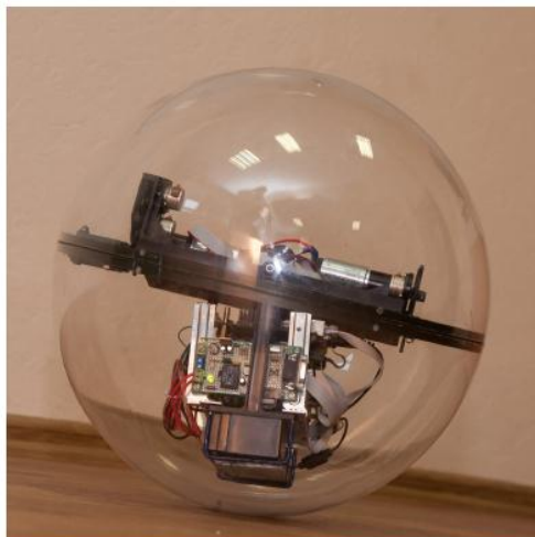
Сфероробот с маятниковым двигателем
